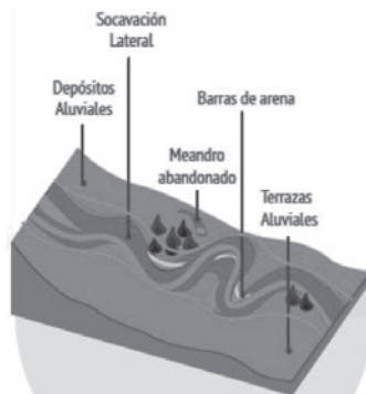
Figura 6-5. Componente geomorfológico (línea naranja) para tramos sinuosos en corrientes de montaña.
