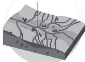
Figura 2-10. Esquematación de un río recto de montaña con su forma típica en planta.
