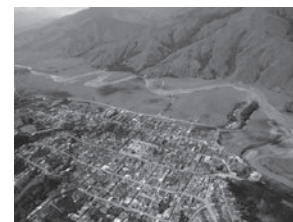
Figura 2-8. Patrón de drenaje sinuoso confinado de un río de montaña. Río Penderisco, municipio de Urao, Antioquia. Foto tomada por Humberto Caballero Acosta.
